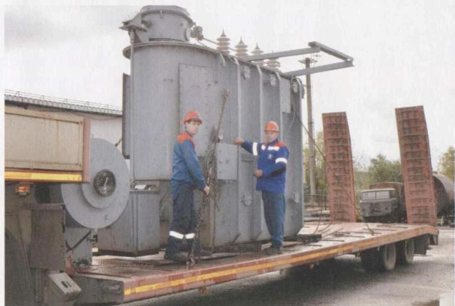
Перевозка трансформатора 35/6кВ с подстанции
